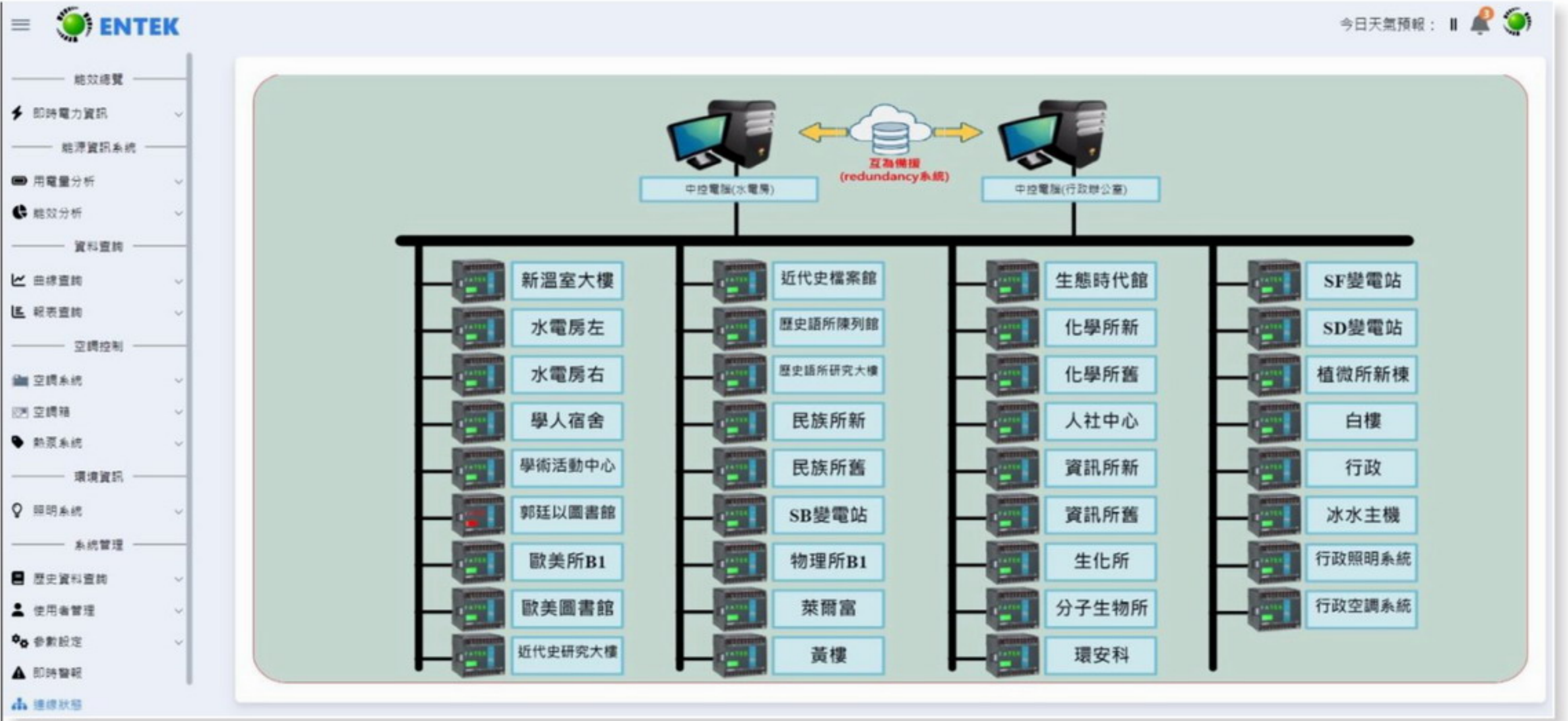
● 院區能源管理系統
