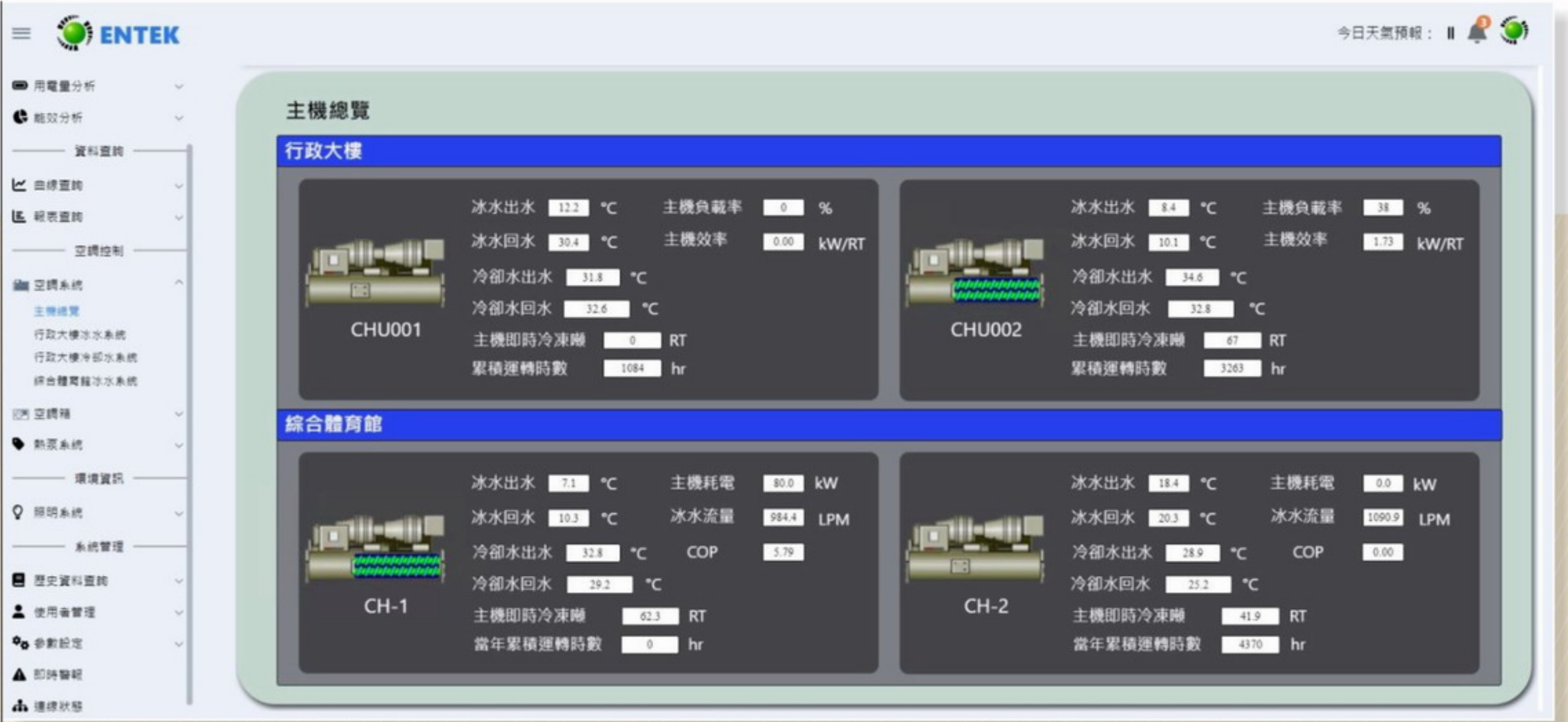
● 重大耗能設備效率即時監控
